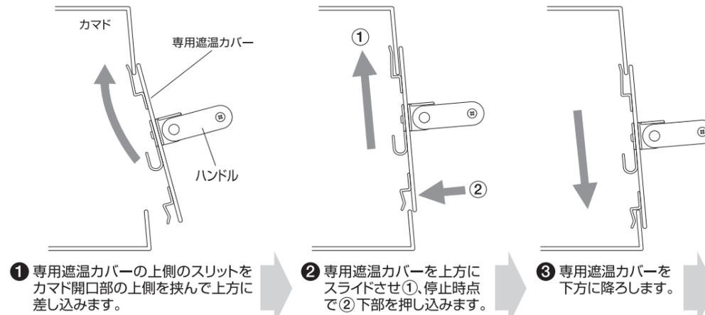
■遮温カバーは装着したまま1cmほどスライドさせることができます。左右にスライドさせ、隙間から燃焼具合や焼き具合を確認できます。また、カマド内の温度管理にも利用できます。
