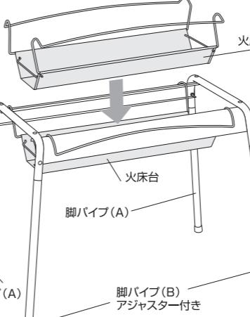
④ 図の要領で、お掃除らくちんカバー・ロストル・焼網の順にセットしてください。各パートのセットが完了したら、グリルにガタツキがないか安定度を再度確認してください。
