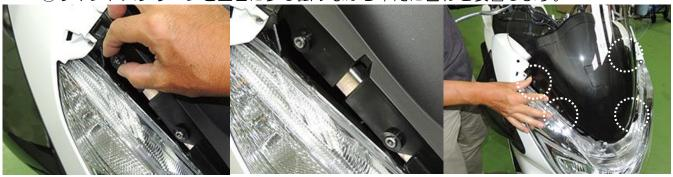
7. ①ウインドスクリーン取り付け穴計4ヶ所の表側に、⑤ゴムワッシャー裏面の保護シートを外し、穴位置を合せて貼り付けてください。(下図右参照)
