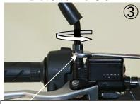
ボルト、アダプター側(下側のナット部分)を緩めて純正ミラーを取外します。
