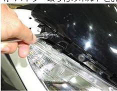
使用工具 10mm ソケットレンチ 5. 純正樹脂ワッシャーを計4個取り外します。
