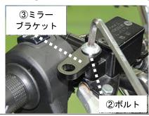
使用工具 六角レンチ 12. 純正ミラーを③ミラーブラケットの穴に通し、④ナットで組み付けします。
