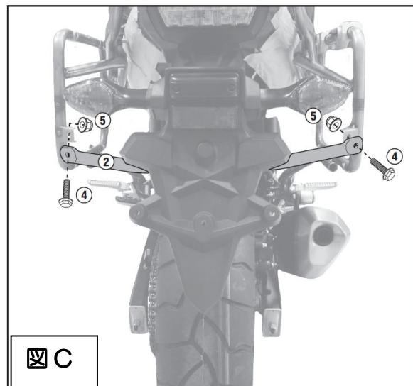
5. 手順1～4で仮組みした各部品の組み付け位置を調整し、問題なければ規定トルク（M8：20N・m、M6：10N・m）で各部品を本締めします。
