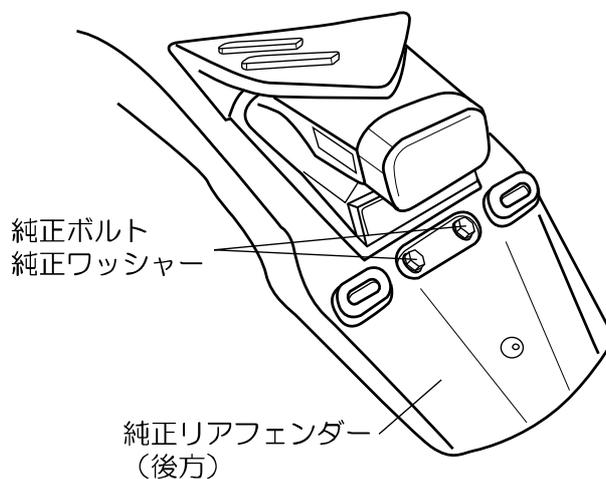
9. 純正リアフェンダーを手で少し持ち上げながら、純正ボルト（2ヶ）を外し、純正アシストグリップ（L）を取り外します。
