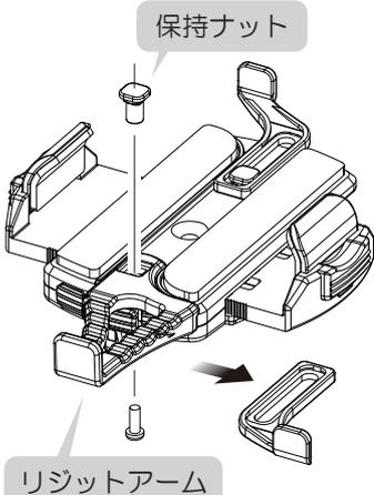
プラスドライバー(別途用意)を使用して本体裏側の下側アーム固定ねじ(中央の白亜鉛メッキねじ)を外し、下側スライドアームと保持ナットを取り外します。
