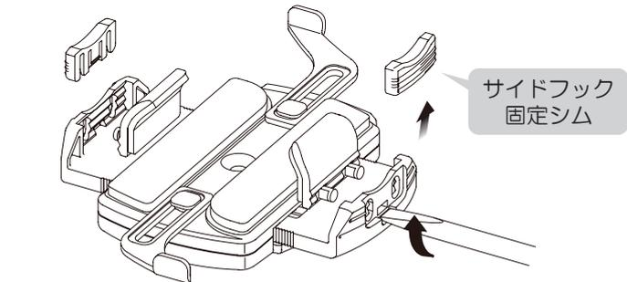
組み付け高さを確認のうえ(山と谷を確実に合わせる)、フックをウイングの端いっぱい押し付けながら、外側に飛び出すピンの上に固定シムを被せ、奥までいっぱい押し込み固定します。
