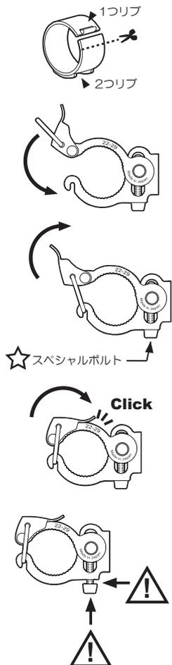
ハンドル外径に合わせて以下の部品を選択します。ハンドル側には 30mm 以上の組み付けスペースが必要です。
