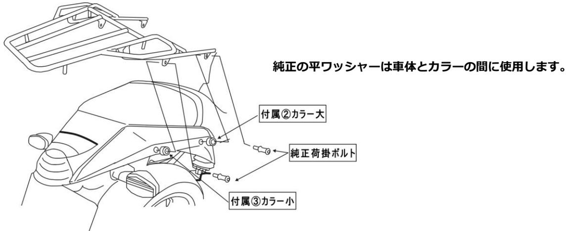
ボルトの取り付けは 4 本全部を取り付けてから締め付けを行ってください。
