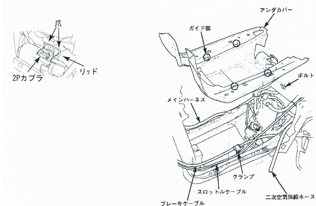
8. フューエルレベルセンサーハーネスがタンクとタンクカバーの間にはさまっていない事を確認し、タンクキャップを外し、タンクカバー（別売）を取付けます。シートフレーム／フロントボックス／タンクキャップ／カブラ類を元に戻します。
